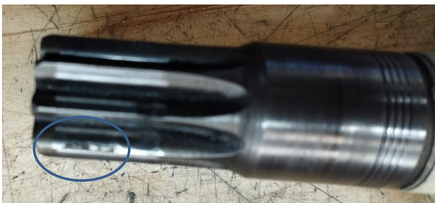
Obr 4. Poškodenie ozubeného prevodu
