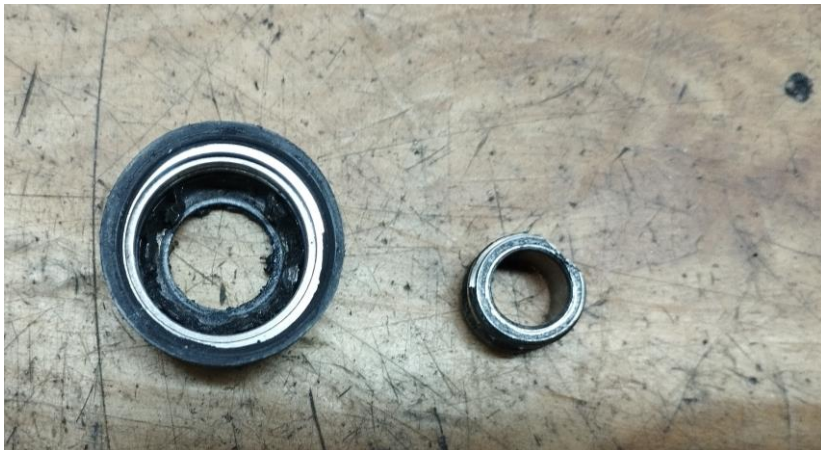
Obr.2 Rozpadnuté ložisko rotora
